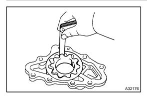
(d) Check the rotor tip clearance.
